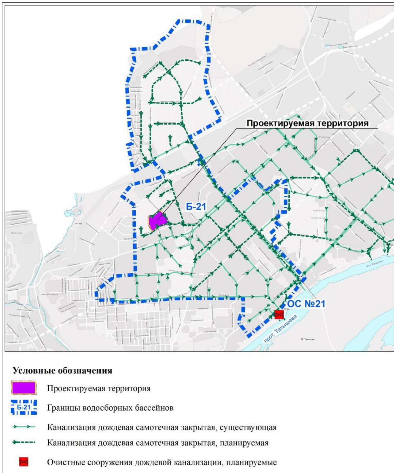
Рисунок 11 – Схема водосборных бассейнов г. Красноярска
