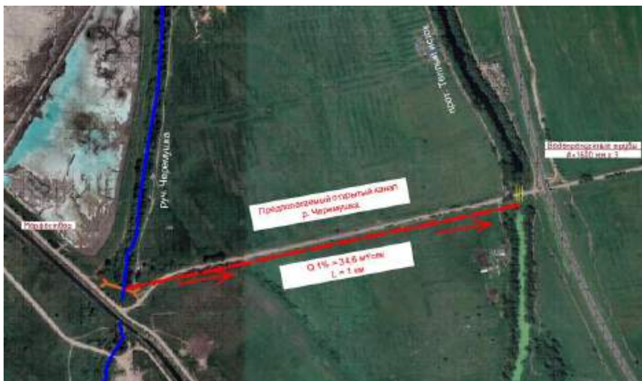
Рисунок 8– Схема отвода ручья Черемушка
